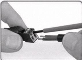
Zum Anschluss feindrähtiger Leiter Klemmfeder mittels Schraubendreher, Klingenbreite 2,5 mm, betätigen und abisolierten Leiter bis zum Anschlag einführen. Eindrähtige Leiter können direkt gesteckt werden.
